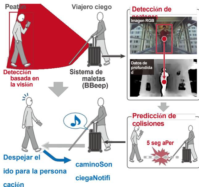
**Figura 1: BBEEP es un sistema de asistencia para maletas que utiliza la retroalimentación sónica para alertar tanto al usuario ciego como a los peatones videntes cercanos sobre posibles riesgos de colisión.**
